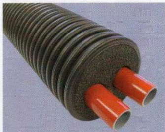
Flexalen Rohr mit gewelltem Außenmantel aus Polyethylen, einem flexiblen geschlossenzelligen Polyolefinschaum und Polybuten-mediumrohren.
